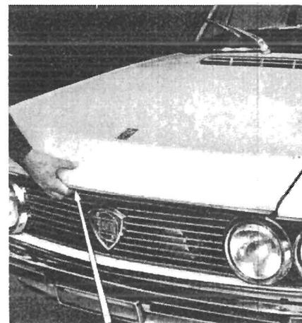
Tirare a fondo corsa la leva posta sul lato sinistro sotto la tavola porta-apparecchi per sbloccare il coperchio del cofano. Sbloccato, il coperchio si socchiude e l'apertura completa è solo possibile premendo l'apposita leva dell'arresto di sicurezza. Un'asta permette il fissaggio in posizione di apertura completa. Il vano motore è illuminato da una lampada che si accende all'apertura del coperchio, con luci di posizione inserite.
